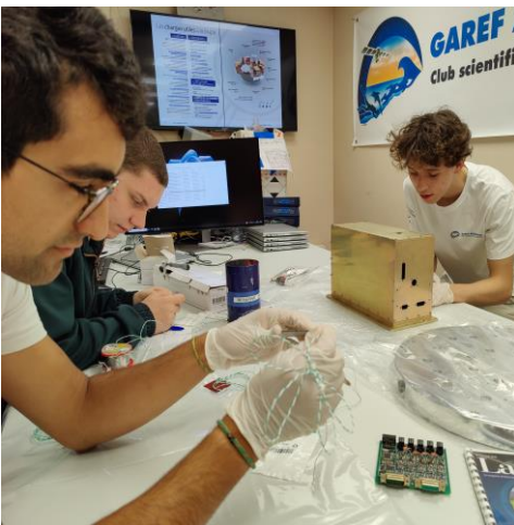
Installation des thermocouples dans les plaques de mesure.
