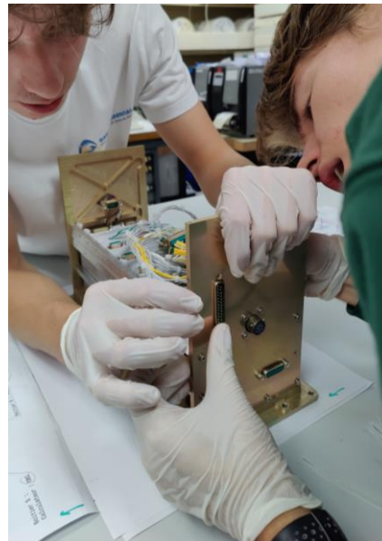
A gauche : installation du toron de câbles dans PariSat A droite : Antenne fixée sur la structure de PariSat
