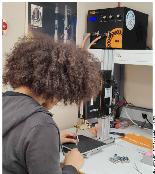
Atia, co-responsable de la mise en œuvre du système d'alimentation de PariSat , connectant une pile
