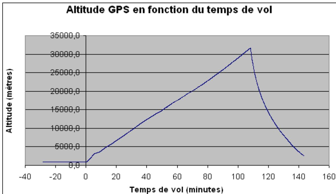
Le graphe montre l'altitude GPS de la nacelle en fonction du temps.
