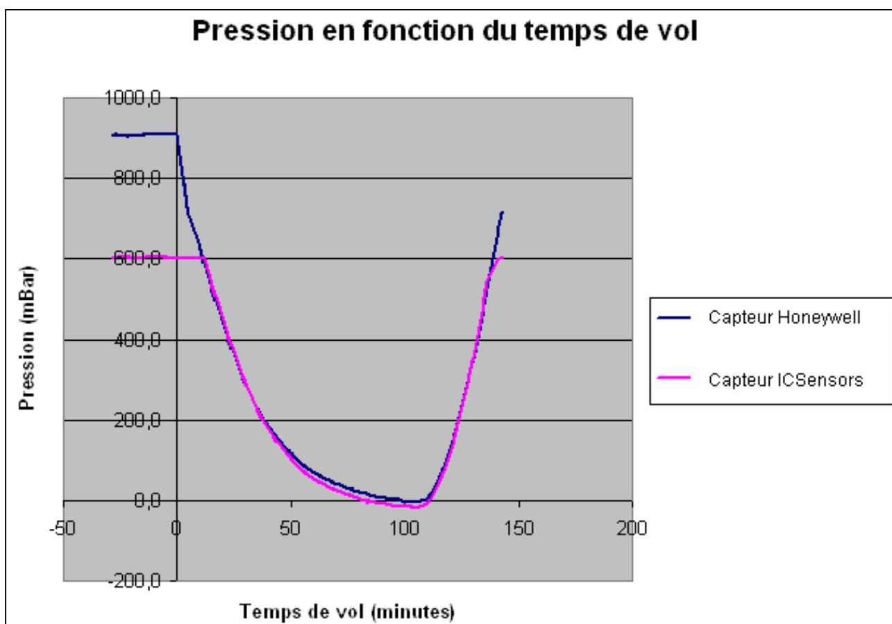
On n'observe aucun parasite, ce qui prouve là encore que le blindage a été efficace par rapport à HORUS III et l'allure de la courbe est vraisemblable : elle correspond visiblement à une fonction exponentielle de l'altitude, comme le précise le modèle de la norme de l'atmosphère standard
