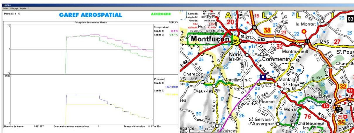
Le deuxième PC possède un autre programme développé en Visual C++ 6.0, qui analyse et recompose les photos transmises grâce à un algorithme correcteur d'erreurs. Il est ensuite utilisé pour les afficher en attendant la suivante.
