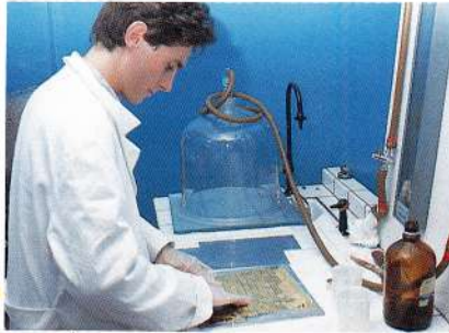
Premières réalisations de structures en matériaux composites (fibres d'aramides moulées dans une résine époxy).
