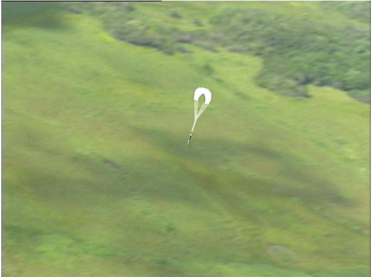
Descente de la charge utile sous parachute, filmée d'hélicoptère en vidéo. (TCVidéo=19 :41 :0,56s) TU=18 :19 :41,560s. Atalante est à 300m d'altitude, 28,5 secondes avant de toucher le sol à une vitesse de 10,5 m/s
