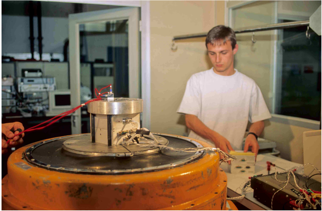
LRBA Vernon. Essais en vibrations du séquenceur pyrotechnique.
