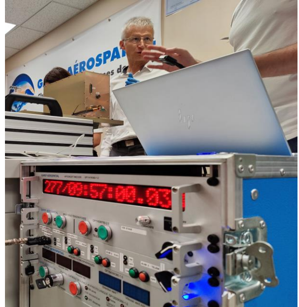
Boîtier de surveillance des états internes de PariSat
