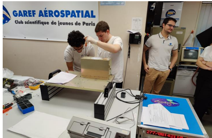
Fixation de PariSat sur son support de vol
