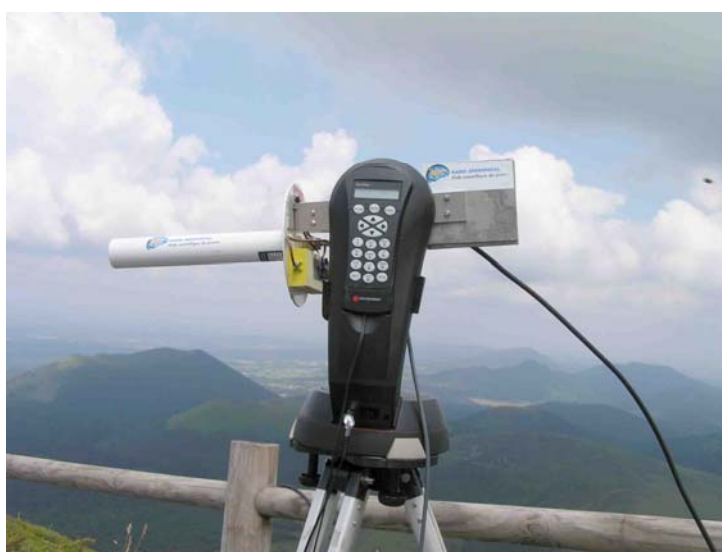
G06N064 – L'antenne sur support asservi
