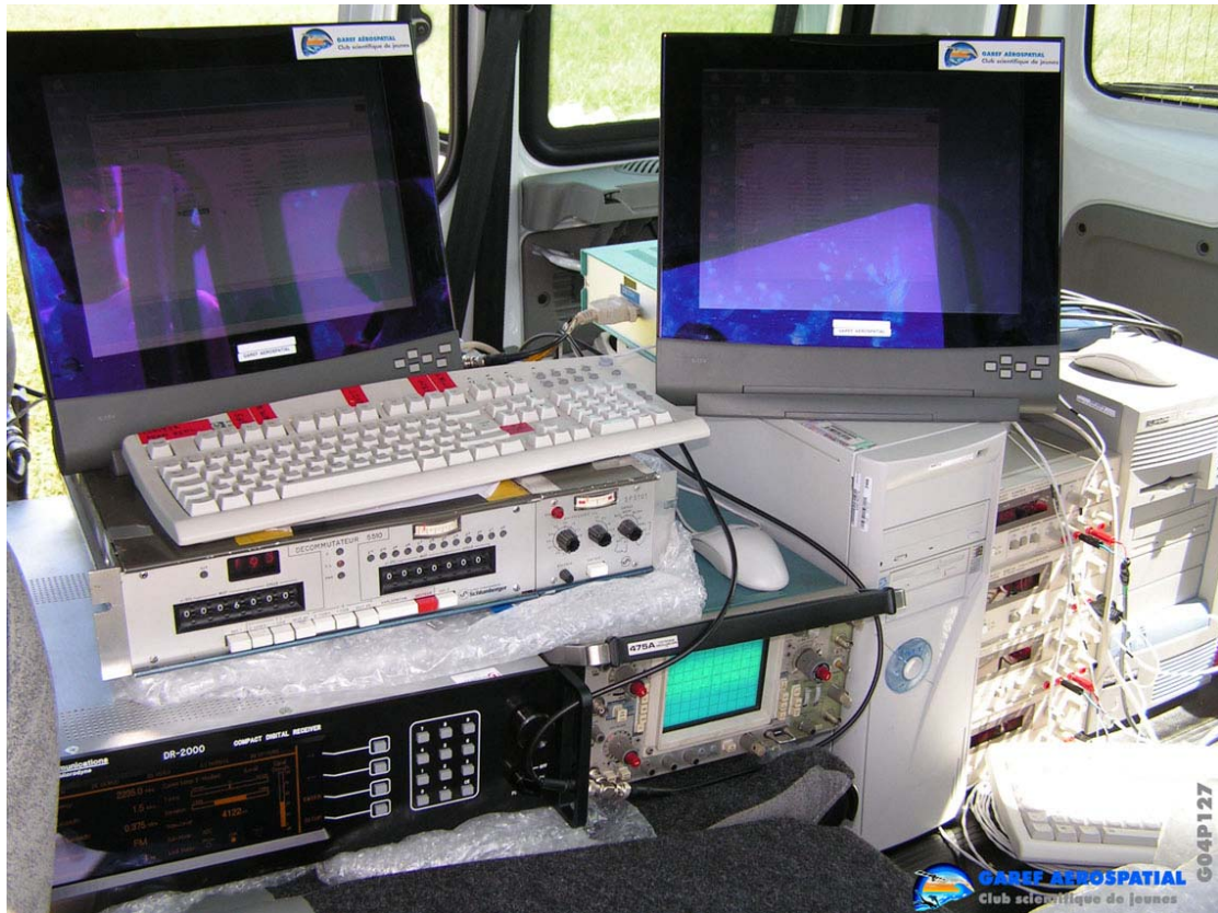
G04P127 Une partie de la chaîne de réception, installée dans le véhicule Kangoo du GAREF
